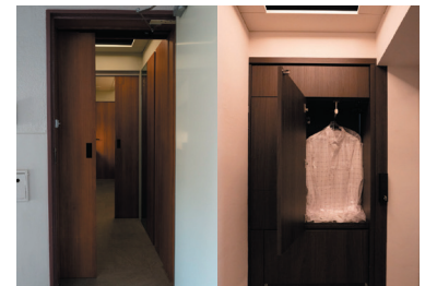
図51 スマートロッカー機能を持つ玄関のロボット家具
