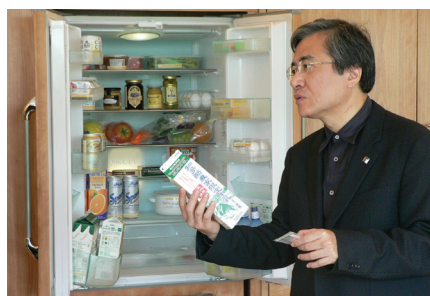
図14 冷蔵庫の中のものにはRFIDが貼られ管理される。残り物を使ったレシピを検索し情報ディスプレイに表示させることもできる
