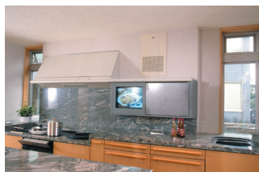
図6 電腦キッチン。調理台の上にある画面がコンピュータ制御調理支援システムの画面。調理指示映像の表示とタッチスイッチを兼ねる。手前にも同様のディスプレイがある
