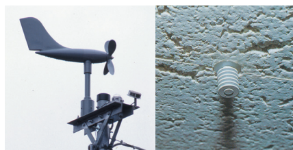
図2 屋外の気象センサー群と室内天井の熱感センサー
