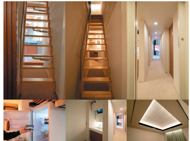
図53 (上) 通路とロフトへの階段を兼用する自動制御のロボット階段 (下) 冷蔵庫収容センサーをはじめ室内に多数のセンサーを設置
