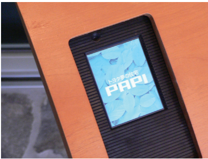
図10 T-Engineを利用した来客者受付端末を玄関に設置
