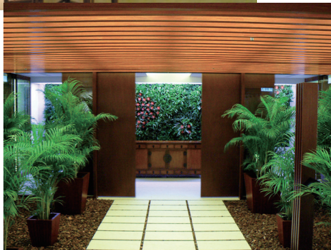
図16 自動給水緑化壁を多用した屋内
