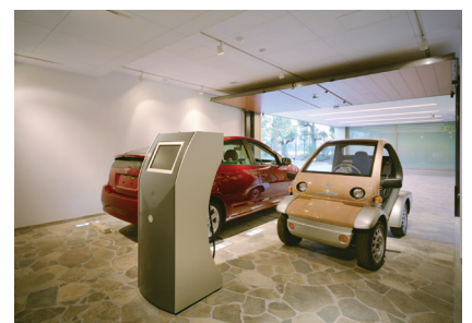
図15 ガレージのハイブリッドカーと電気自動車。電気自動車への給電用のステーションを使い、非常時にはハイブリッドカーで発電した電気を住宅に逆供給できる
