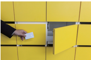
図 33 学生用ロッカーはすべてAPI制御で取っ手も鍵穴も番号もなく、学生はプログラムしないと使えない
