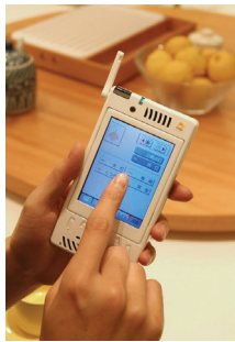
図11 館内の設備はUCから統合的にコントロールできる
