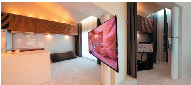
図54 1台の大型TVをさまざまなエリア向けに使える自動制御の可動テレビ台
