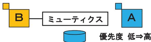
ミューティクスをロック（資源を占有）した時点で目的のタスクの優先度を上限まで（生成時で指定した値まで）引き上げます。資源をロックすると優先度が変わるため、優先度逆転現象が回避できます。
