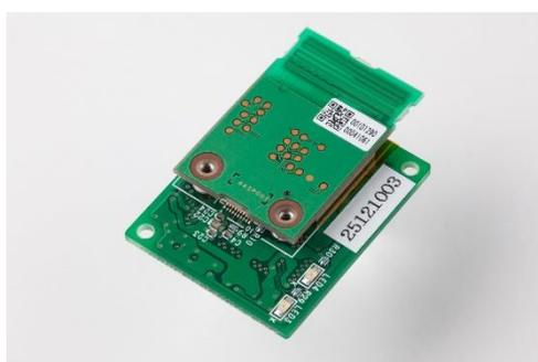
図 1-3 無線モジュールと合体式の IoT-Engine の例
